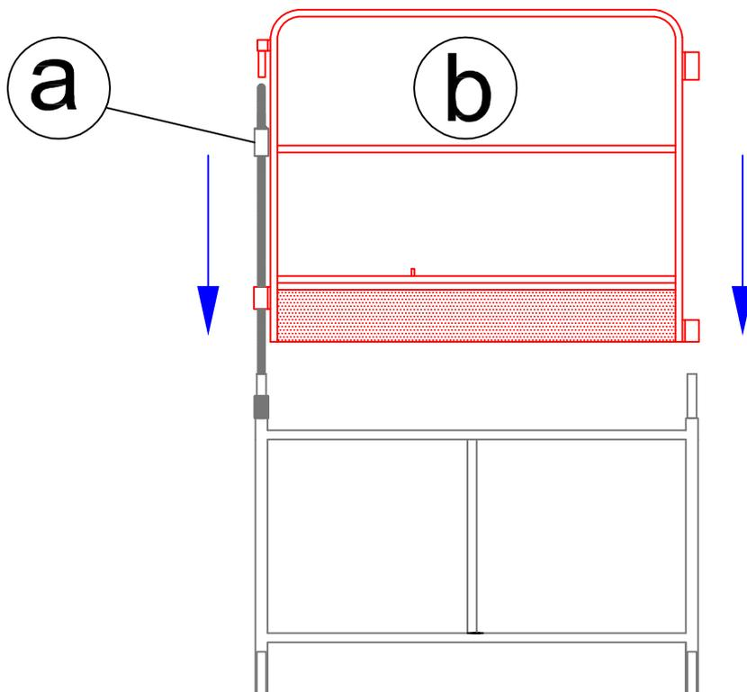
2º Encaixe, o proximo guarda corpo, no sentido horário. atentando para o posicionamento dos encaixes, um sobre o outro.
