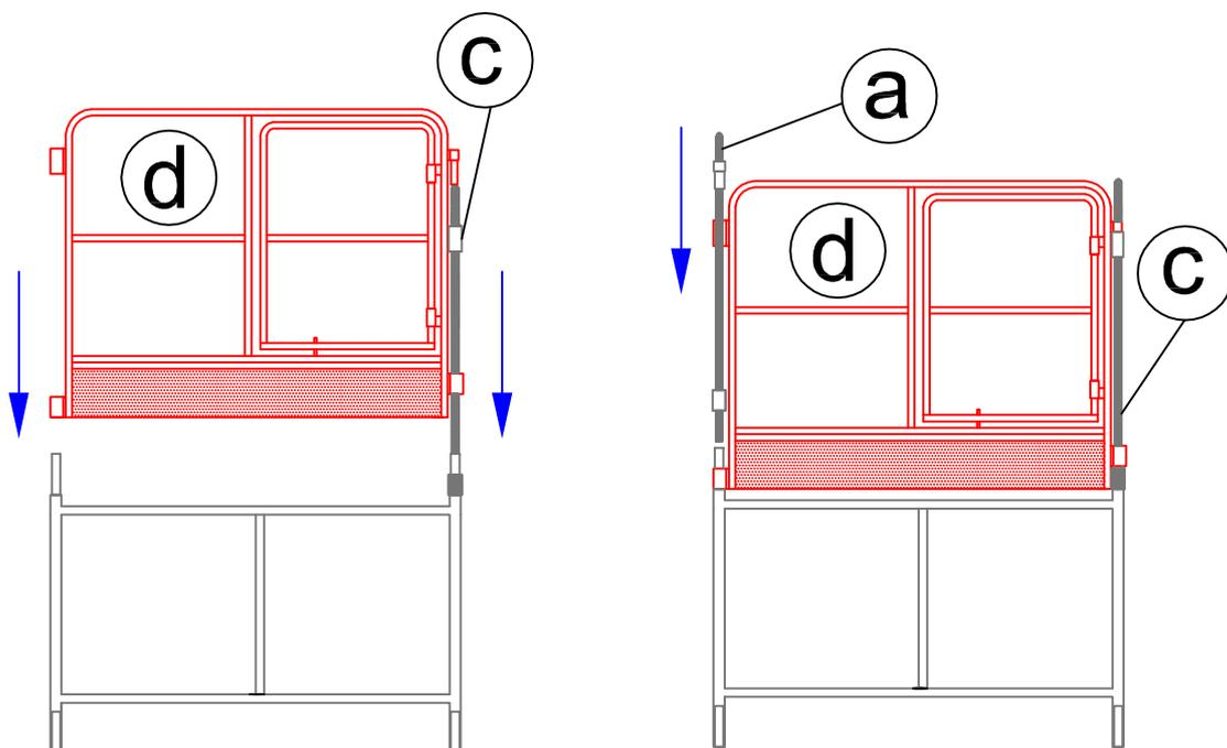
4º Encaixe o ultimo guarda corpo no sentido horário.e por ultimo encaixe o primeiro guarda corpo (a).
